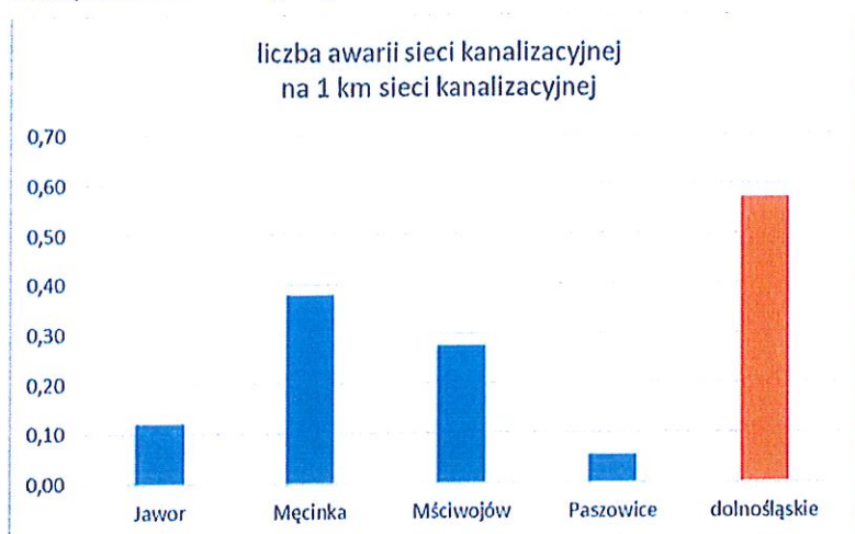
Rysunek 5. Liczba awarii sieci kanalizacyjnej na 1 km sieci w gminach aglomeracji Jawor w porównaniu do województwa dolnośląskiego
