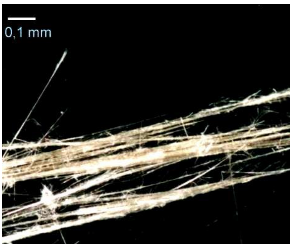
Rysunek 2 Azbest amozytowy (grupa azbestów amfibolowych)
