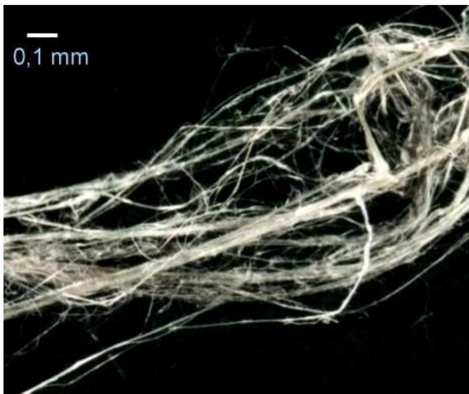
Rysunek 1 Długo włóknisty azbest chryzotyłowy praktycznie zawierający zanieczyszczeń (Chiny)
